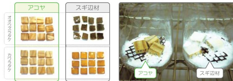
JIS K1571「木材保存の性能試験及び性能基準」による耐朽性能試験。
