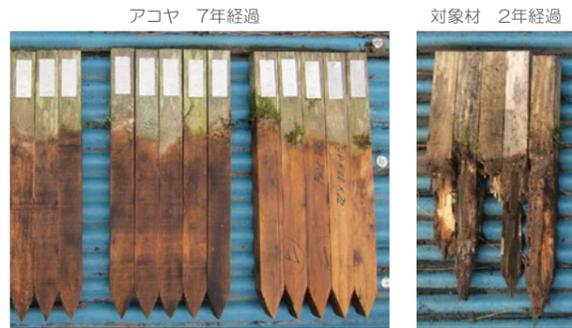
JIS K1571「木材保存の性能試験及び性能基準」に沿って実施した屋外防蟻性能試験。試験開始から7年経過後も、アコヤには、シロアリによる食害が一切見られません。
