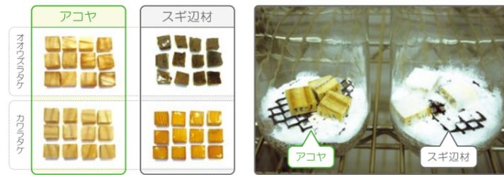
JIS K1571「木材保存材の性能試験及び性能基準」による耐朽性能試験。
