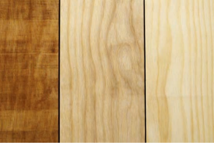
製材品の変色、および製材品の表面から 3mm（0.12 インチ）削った後と 6mm（0.24 インチ）削った後の状態
