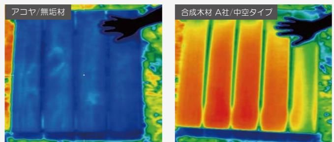
アコヤを使用したデッキパネルの表面温度は、摂氏45~46度程度。地面より低い温度に保たれていることが分かります。サーモウッドのデッキパネルは、地面とほぼ同じ温度です。測定に使用した3種類の合成木材は、いずれも地面より、かなり高い温度に昇っています。特にB社の合成木材は摂氏56~58度を示し、非常に高温です。
