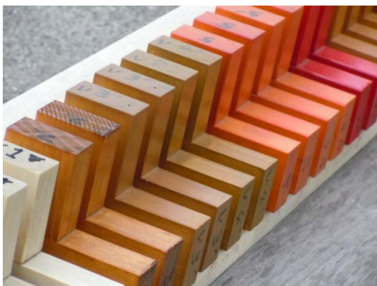
写 2-4 L 字接着塗装 試験片の屋外暴露風景
