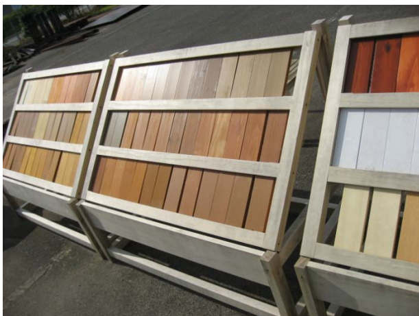
写 2-24 塗装試験片の屋外暴露風景
