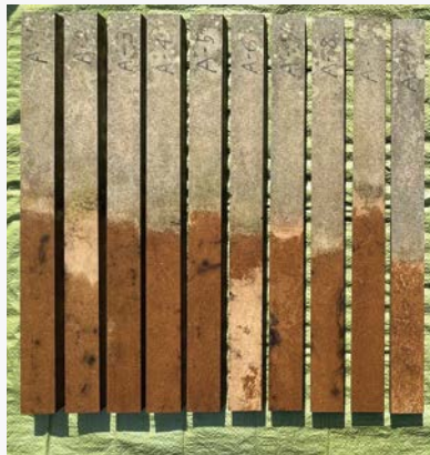
野外防腐防蟻試験 JIS K1571準拠 (鹿児島県)
