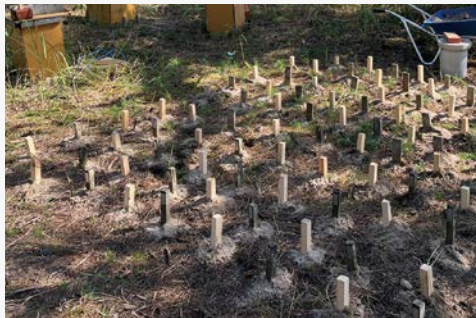
野外防腐防蟻試験 JIS K1571準拠 (鹿児島県)
