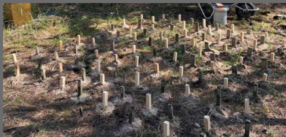
野外防腐防蟻試験 JIS K1571 準拠 (鹿児島県)
